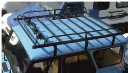
Рис. 20.19 Багажник на крыше с лестницей
