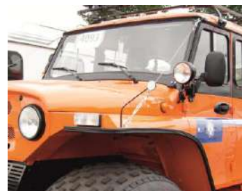
Рис.20.21 Фары-прожекторы с ручками, управляемые из окон ВТС
