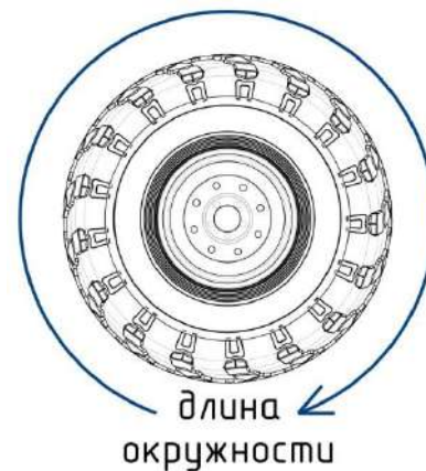
Рис. 10.2 Длина окружности колеса
