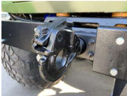
Рис.20.28 Буксирный прибор (фаркоп) с розеткой
