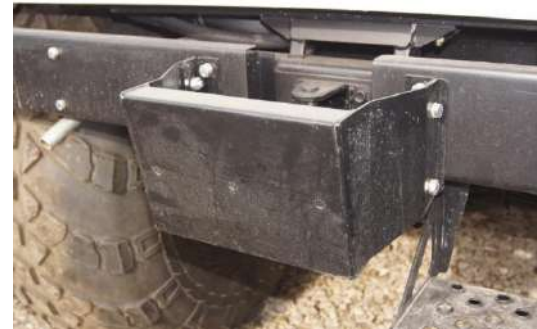
Рис.20.30 Буксирный прибор (фаркоп) с розеткой
