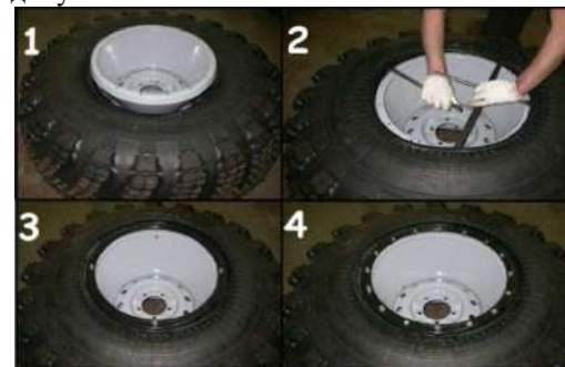
Рис. 10.4 Порядок монтажа шины ТРЭКОЛ
